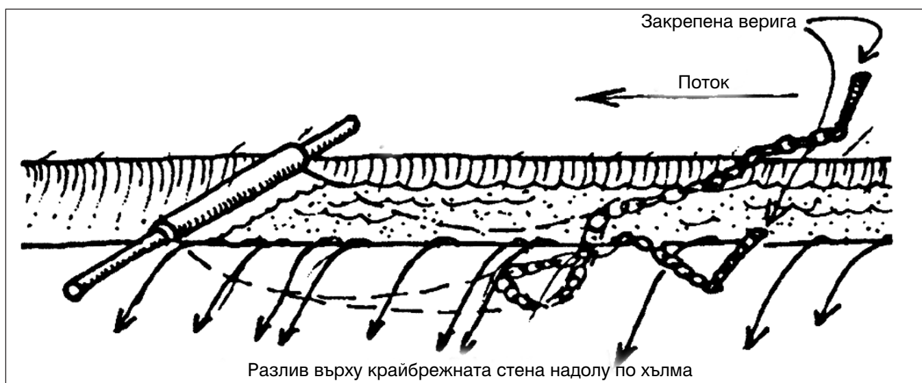
Рисунка 2.20. Временният язовир се изгражда на необходимото място направо на отводнителните канали. Единият край на парче полиетилен се закрепва за края на канавката, а към другия край се закача метален синджир, който се разполага по дължината. При препълване на язовирчето водата изтича от него и напоява почвата надолу по склона
