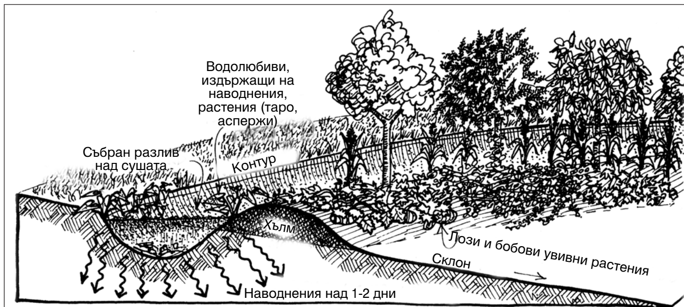
Рисунка 2.21. Канавките с насип са изградени по хоризонталите и служат не за транспортиране, а за събиране на дъждовна вода, която след това бавно попива в почвата. Насипът обикновено се засажда с дърветата и храстите. След като преминат първите дъждове и водата попие на метър и повече в земята, може да се пристъпи към засаждането на дърветата върху насипите или в пространството между канавките. Засаждането може да се извърши в продължение на два дъждовни сезона
